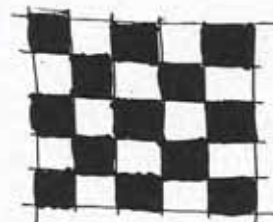
Licht-donkerpatroon door kleurverschil en de schaduw van terugliggende gevelvlakken.
