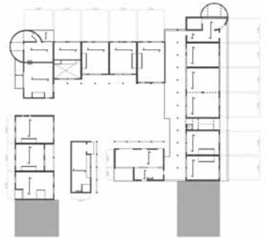
constructieve elementen, overspanningsrichtingen
