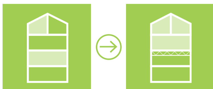
Van ongeïsoleerde woning naar geïsoleerde woningscheidende vloer
