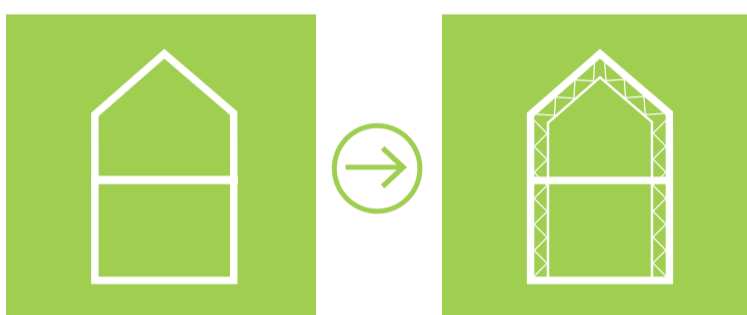
Van ongeïsoleerde woning naar volledige geïsoleerde gevels en dak
